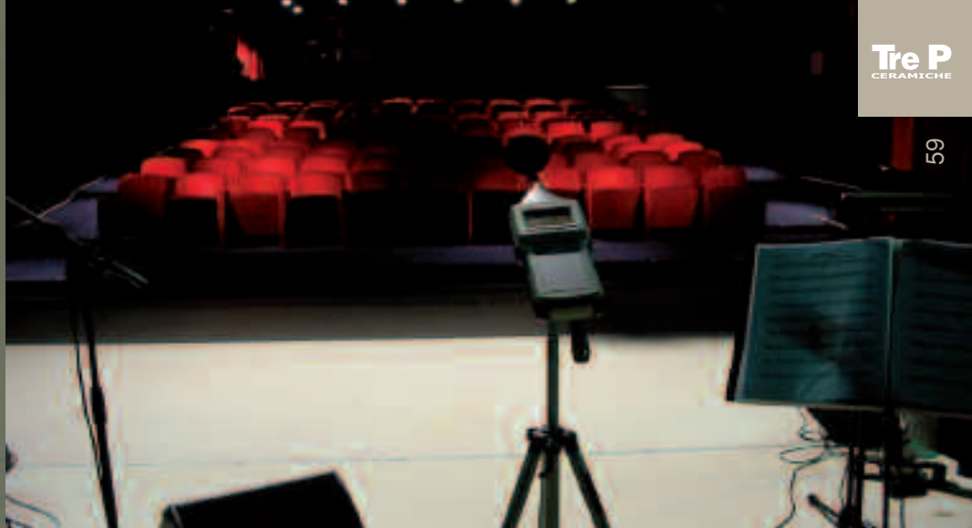
Rilievi fonometrici all'interno di un teatro
